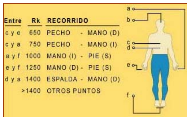
Fig. 1.11 Recorridos de la corriente en el cuerpo humano.
